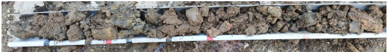
Sondage n°15 : Aucune trace rédoxique visible (Classe Ia : zone non humide)
